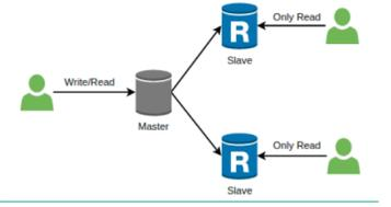
主从复制的优势 ○ 由于从节点只处理只读请求，那么据此可实现数据的读写分离，将数据读取的负载均摊在多个从节点上，从而降低主库压力并提升系统效率
