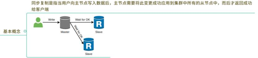
基本概念 ○ 同步复制是指当用户向主节点写入数据后，主节点需要将此变更成功应用到集群中所有的从节点中，而后才返回成功给客户端
